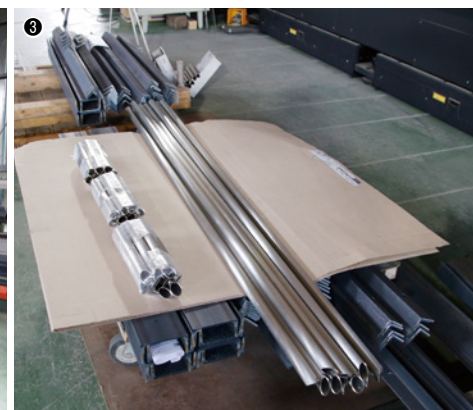
①パイプインデックス装置用CAM Dr.ABE_Tubeにより、ENSIS-RIの加工プログラムを作成する／②加工するパイプ・形鋼は丸パイプ・角パイプ・チャンネル・アングルなどで、材質もさまざま／③ENSIS-RIで加工したパイプ・形鋼
