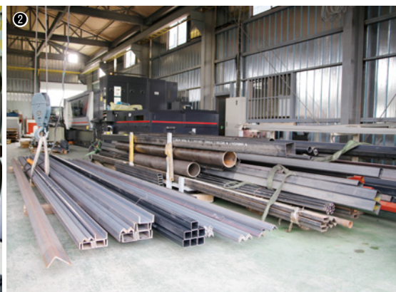
①パイプインデックス装置用CAM Dr.ABE_Tubeにより、ENSIS-RIの加工プログラムを作成する／②加工するパイプ・形鋼は丸パイプ・角パイプ・チャンネル・アングルなどで、材質もさまざま／③ENSIS-RIで加工したパイプ・形鋼
