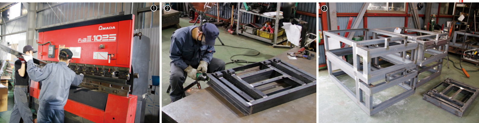
①FBDⅢ-1025による曲げ加工／②溶接工程。パイプ・形鋼を用いてフレーム構造の各種架台・筐体を製作する／③溶接組立が完了した架台
